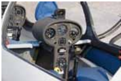
Figura 5. Strumentazione e controlli di volo del sedile posteriore dell'aliante.
