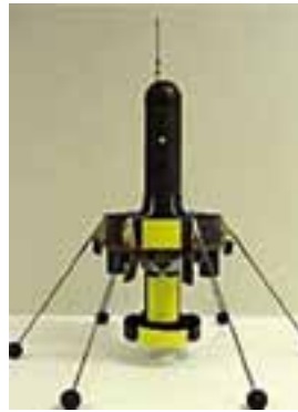
Da sinistra. Figura 11. Il drone Honeywell T Hawk MAV - Figura 12. L'UAV Cypher II Dragon della Sikorsky Aircraft Corporation (diametro: 1,88 m; altezza: 61 cm; diametro del rotore: 1,22 m; velocità massima: 233 km/h; raggio d'azione: 185 km; autonomia: 2-3 ore) - Figura 13. Lo Heli Spy II della Micro Autonomous Systems LLC (diametro: 28 cm; altezza: 69 cm; velocità: 121 km/h; autonomia: 30 minuti; vola in posizione verticale ma alla massima velocità si inclina in avanti di 60 gradi ) - Figura 14. Il velivolo iSTAR VTOL della Allied Aerospace Industries Inc. (ora Triumph Aerospace Systems).
