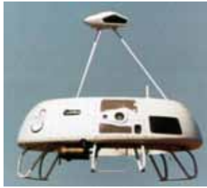
Da sinistra. Figura 11. Il drone Honeywell T Hawk MAV - Figura 12. L'UAV Cypher II Dragon della Sikorsky Aircraft Corporation (diametro: 1,88 m; altezza: 61 cm; diametro del rotore: 1,22 m; velocità massima: 233 km/h; raggio d'azione: 185 km; autonomia: 2-3 ore) - Figura 13. Lo Heli Spy II della Micro Autonomous Systems LLC (diametro: 28 cm; altezza: 69 cm; velocità: 121 km/h; autonomia: 30 minuti; vola in posizione verticale ma alla massima velocità si inclina in avanti di 60 gradi ) - Figura 14. Il velivolo iSTAR VTOL della Allied Aerospace Industries Inc. (ora Triumph Aerospace Systems).
